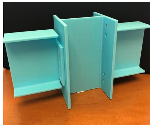
(d) Connection 4 – End-plate Moment Connection
